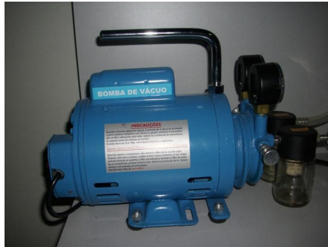
Figura 5 – Bomba de vácuo.
