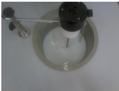
Figura 1 - Tanque de polipropileno com agitador do Módulo Filtração à Vácuo UpControl.
