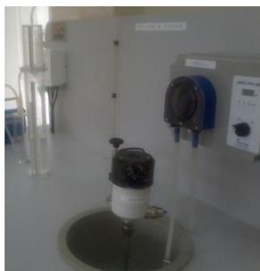
Figura 2 - Bomba peristáltica provitec para alimentação do filtro.
