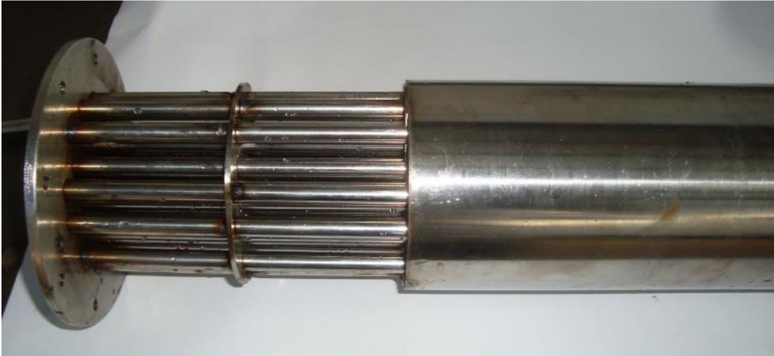
Figura 19 – Montagem dos tubos, espelhos , chicanas e a carcaça
