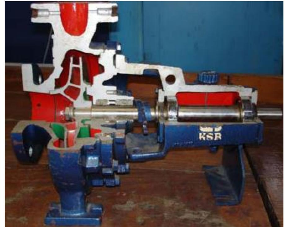
Figura 4 – Esquema de uma bomba centrífuga
