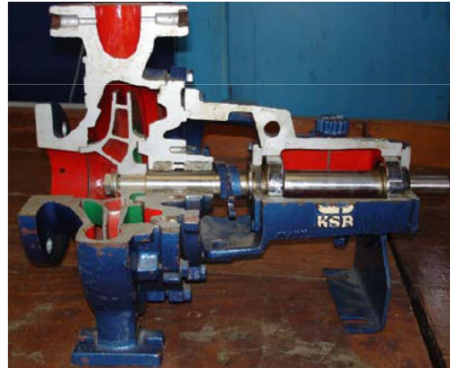
Figura 4 – Esquema de uma bomba centrífuga
